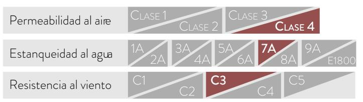
Ensayo de referencia sobre ventana de 3000 x 2500 mm
