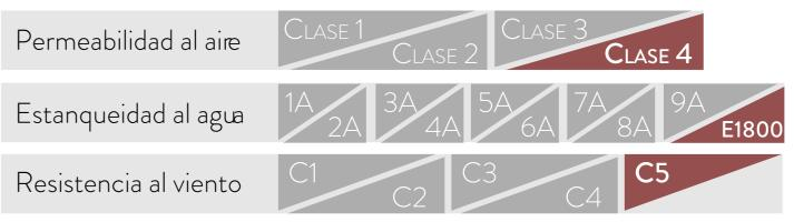
Ensayo de referencia sobre ventana de 1700 x 2500 mm
